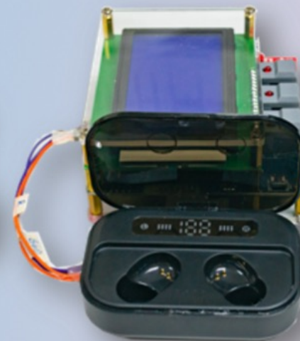
测试盒与快速升级配对工具 量产快速测试，晶振校准，程序有线，无线升级
