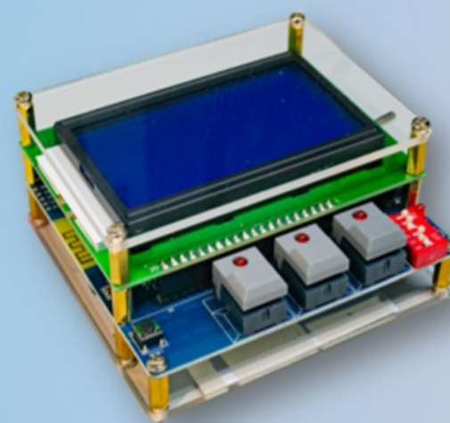
测试盒与快速升级配对工具 量产快速测试，晶振校准，程序有线，无线升级
