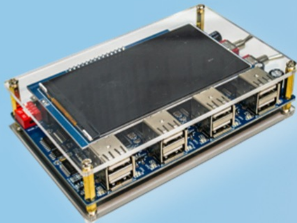
一拖八 烧写器 PCBA在线烧写
